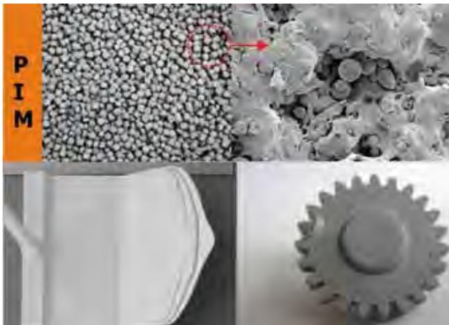
Zur Herstellung komplexer, einbaufertiger oder endkonturnaher gesinterter Formteile aus Metall oder Keramik wird das Pulverspritzgießen (PIM) angewendet.
