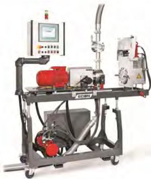
In diesem Projekt soll gemeinsam unter der Führung von Econ mit mehreren Partnern die Technologie der Unterwassergranulierung von thermoplastischen Kunststoffen soweit adaptiert werden, dass diese auch Mikrogranulate ( $\text{Ø} < 0.75 \text{ mm}$ ) produzieren kann. Dafür wird der geschmolzene Kunststoff durch eine Lochplatte gepresst und in einem Wasserstrom von einem rotierendem Messerkopf abgeschnitten.
