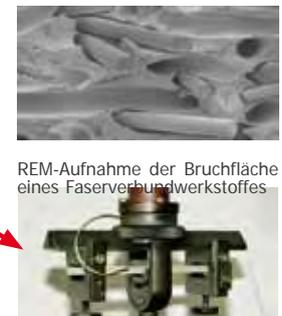
REM-Aufnahme der Bruchfläche eines Faserverbundwerkstoffes
